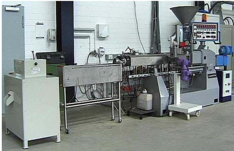
*Extrusionslinie, die zur Verarbeitung (Compoundierung) von Kunststoffzyklen eingesetzt wird*
