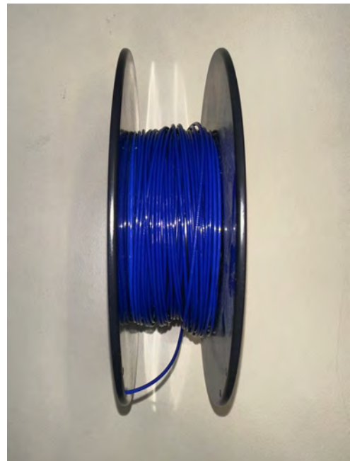
Abbildung 3.10: Aufwicklung von Filament aus eigener Herstellung. Sehr unsauber und häufig schräge Stränge. [Eigene Darstellung]
