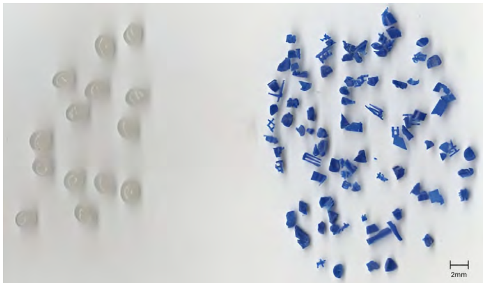
Abbildung 6.14: Vergleich von Kornform und Korngröße: Virginmaterial (unbearbeitet) und Mahlgut [Eigene Darstellung]
