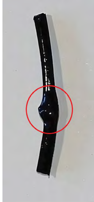
Abbildung 6.9: Filamentstrang mit Blobs [Eigene Darstellung]
