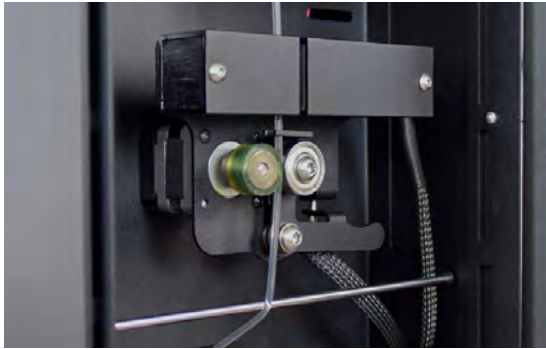
Abbildung 4.2: Infrarot-Durchmessersensor der Firma 3devo [3devo_Sensor]
