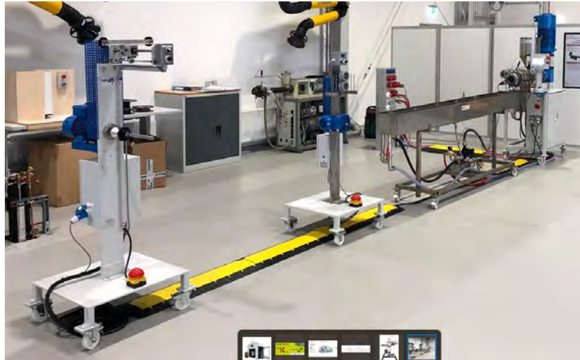
Abbildung 3.2: Extrusionslinie der Firma PMH, Quelle: [PMH]
