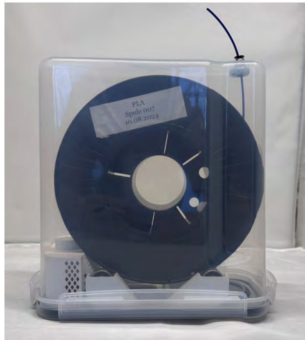
Abbildung 3.16: Verpackung von Filament aus eigener Herstellung. Wiederverwendbare Box mit kleiner Öffnung zur Filamententnahme, Spulenhalter, Silicagel in Behälter, sodass es gewechselt werden kann. [Eigene Darstellung]
