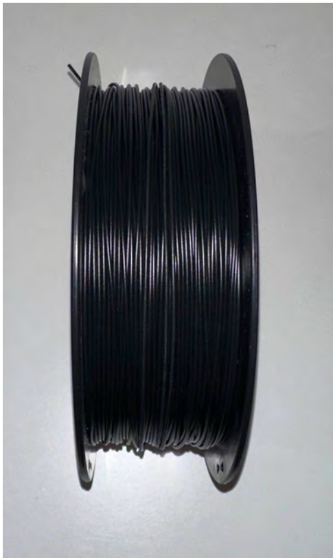
Abbildung 3.5: Aufwicklung von ESun. Etwas ungeordnet, einzelne Stränge verlaufen ein wenig schräg. [Eigene Darstellung]
