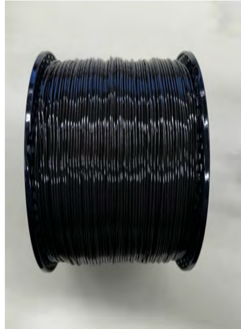
Abbildung 3.8: Aufwicklung von Prusament Recycled. Eher ungeordnet, aber dennoch gerade Filamentstränge. [Eigene Darstellung]
