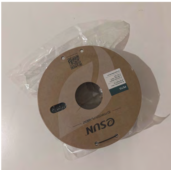
Abbildung 3.11: Verpackung von ESun. Eingeschweißt, vakuumiert, Spule aus Karton, Silicagel in Einwegtüte. [Eigene Darstellung]
