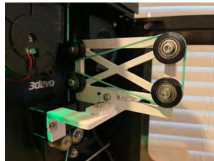
Abbildung 5.3: Möglichkeit 2: Verlängerung der Kühlstrecke [Kuehlung_Moeglichkeit2]
