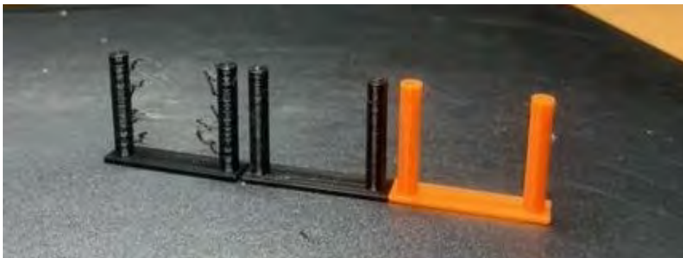
Abbildung 6.7: Einfluss der Filamentfeuchtigkeit auf die Druckqualität bei E-Sun. Links: neues PLA, Mitte: getrocknetes PLA, Rechts: weiteres neues PLA. Quelle: [ESun_Feuchtigkeit]
