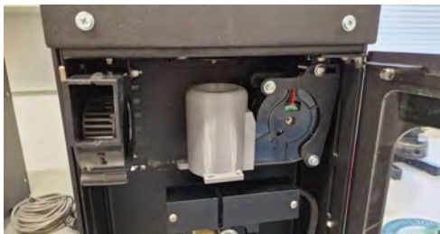
Abbildung 5.2: Möglichkeit 1: 360° Kühlung [Kuehlung_Moeglichkeit1]
