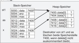
Zwei Zeiger verweisen auf die gleiche Adresse im Heap. Sowohl der Destruktor von as als der von st1 würde diesen Bereich löschen.
