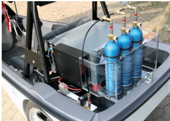
von Links: Studierende am Versuchstand Synchrongenerator; Modell einer Redox-Flow-Batterie für die studentische Ausbildung; 5 kW Redox-Flow-Batterie im Energiepark; CityEL mit Brennstoffzelle als Range Extender
