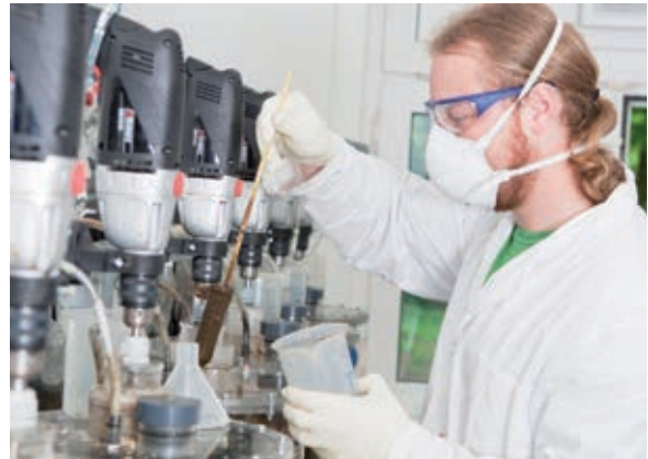
Arbeit an Versuchsreaktoren zur Prozesssimulation von Biogasprozessen
