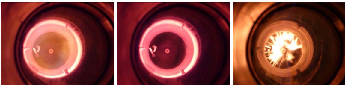
**Abbildung 8-5:** Flammenbild unmittelbar vor (a) nach (b) Abschalten des Primärkreises und nach Zusammenbrechen der flammenlosen Oxidation (c)
