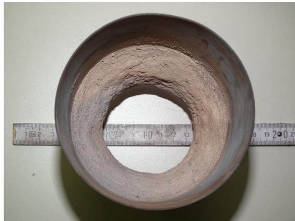
Abbildung 10-1: Flammrohr mit düsenförmiger Querschnittsverengung im Einströmbereich
