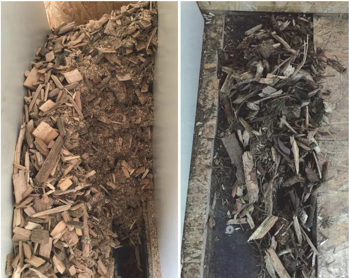
**Abbildung 7:** Links: Entmischung des Brennstoffes durch hohen Feingutanteil (B6a, P45S, WG27,1%, FG10%)
