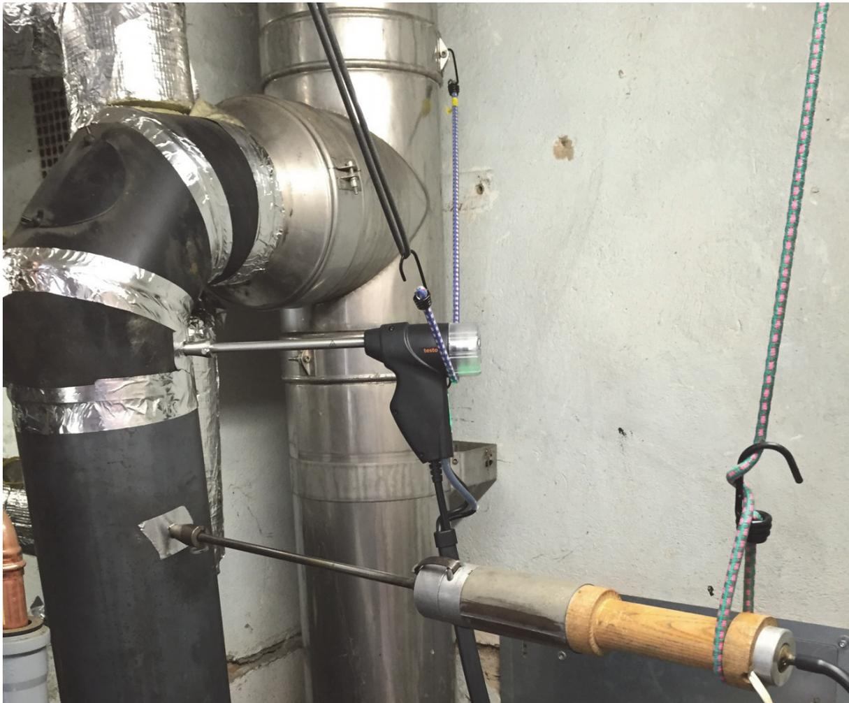
**Abbildung 10: Probenahmestellen für Staub (Wöhler) und Testo (Staub, O<sub>2</sub>, CO<sub>2</sub> und CO)**
