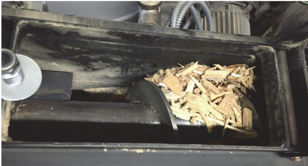
**Abbildung 5: Förderschnecke – Detailansicht bei geöffneter Wartungsklappe**
