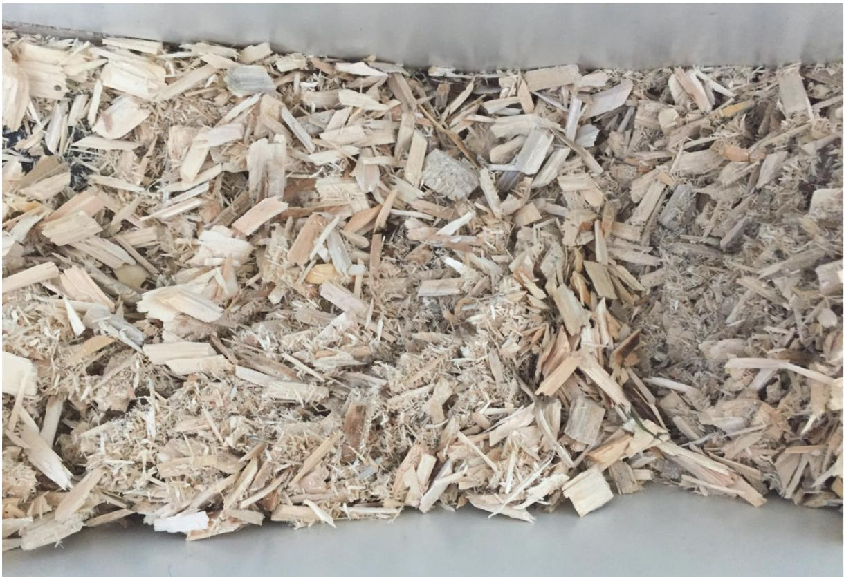
Abbildung 1: Brennstoff mit zugemischtem Feinanteil (B<sub>4a</sub>, P<sub>31S</sub> WG<sub>17,7%</sub> FG<sub>10%</sub>) in der Brennstoffzuführung für die 75 kW-Anlage
